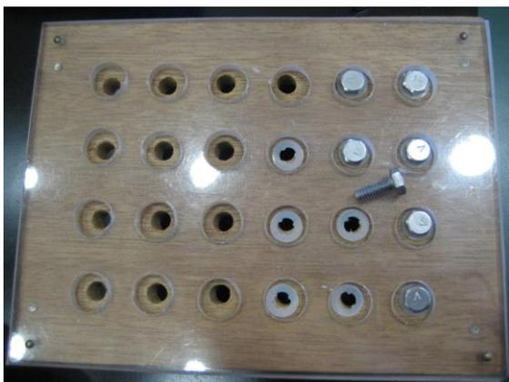
これは同じ新晃空調工業のベルトカバーのシール貼りで使用される治具である。シールがずれないように、木枠がガイドになっている。
